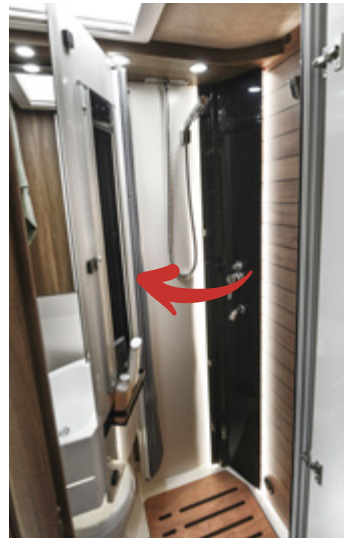
Vario-Bad mit modularem Volumen (P64): zur bestmöglichen Raumnutzung, auch in einem Reisemobil unter 7 Metern.
