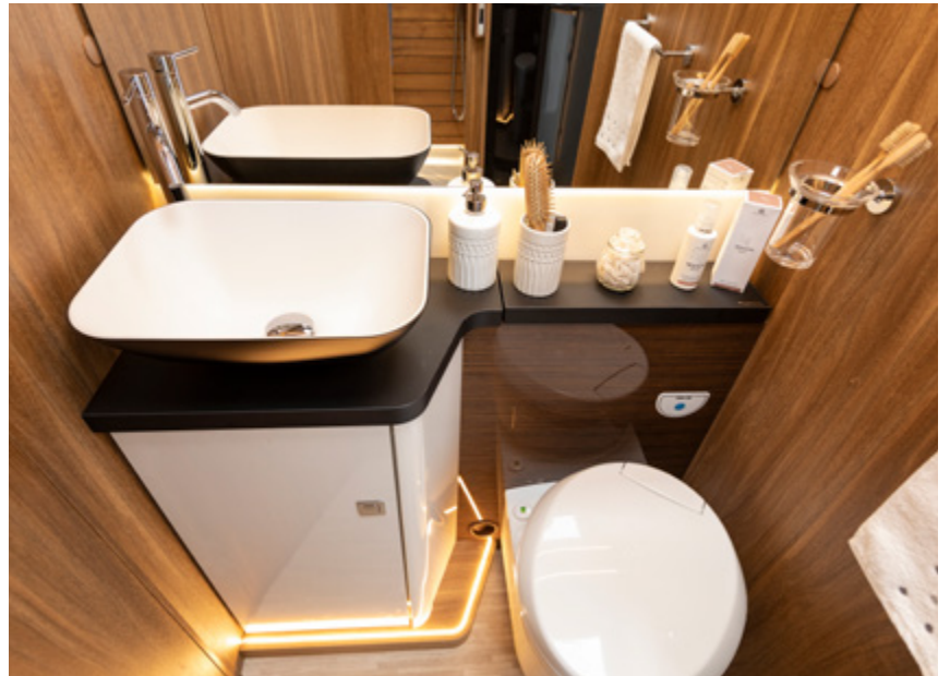
Vario-Bad mit modularem Volumen (P64): zur bestmöglichen Raumnutzung, auch in einem Reisemobil unter 7 Metern.
